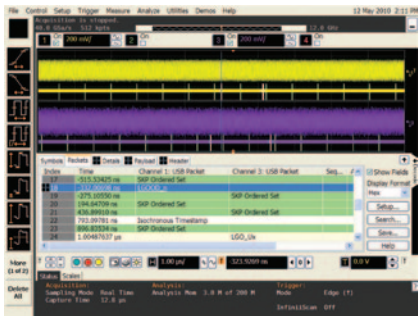
在双向串行数据流上分离信号完整性问题与逻辑电平编码错误。
