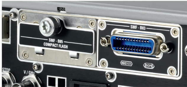
外存储器选件的插入，打开（上面）和关闭
