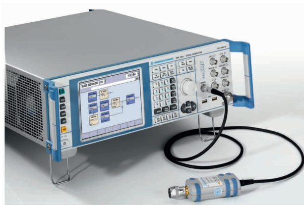
探头接口上连接了一个 R&S®NRP-Zx 功率探头
