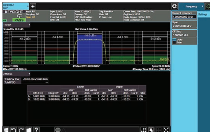
图 6-9. 使用高性能 X 系列信号分析仪进行邻道功率测量
