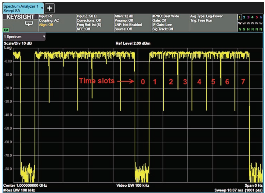
图 2-35. 采用 8 个时隙的 TDMA 信号（本例为 GSM 信号），时隙 0 为“关闭”。
