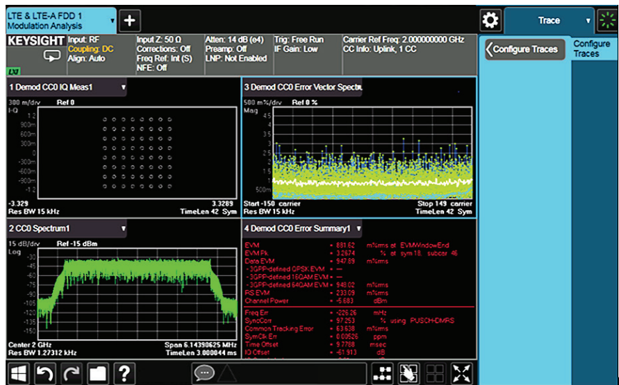
图 8-6. LTE FDD 下行链路信号的 EVM 测量
