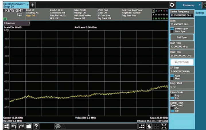
图 7-10. 本底噪声的增加表明随着本振谐波的改变灵敏度发生变化
