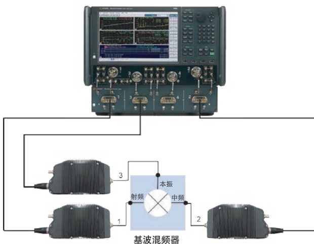
由双激励源 PNA、N5292A 四端口控制器和宽带频率扩展器模块组成的系统可以进行混频器和变频器测量。PNA 的第二激励源可用于为混频器提供本振信号。
