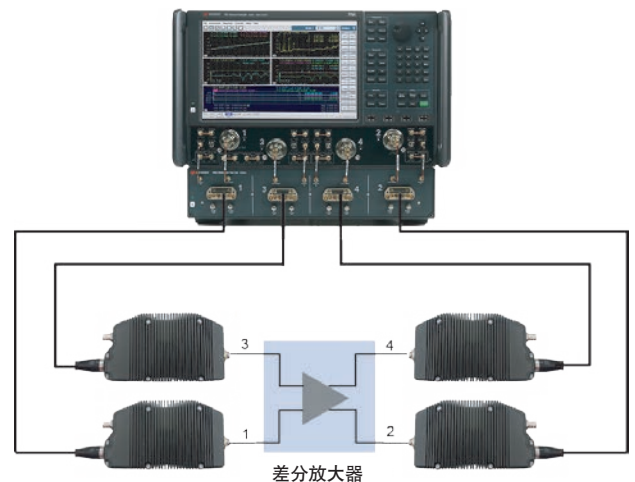
使用四端口 PNA、N5292A 控制器和 N5293A 频率扩展器级成的系统，可以对平衡跨阻放大器进行真正的差分测量。
