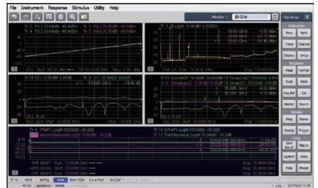
除了 S 参数之外，还可使用频谱分析、增益压缩和差分 I/Q 应用软件来表征 10 MHz 至 125 GHz 放大器。
