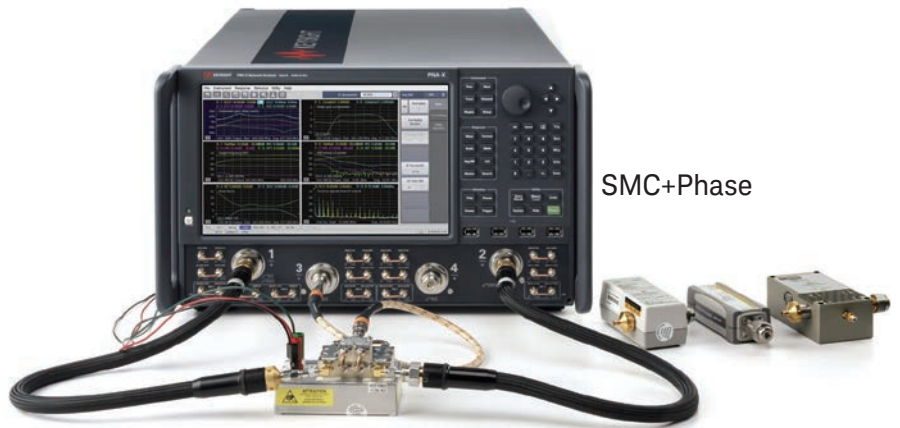
S93083A 标量混频器/变频器相位 (SMC + Phase) 测量法的设置十分简单，无需再使用参考和校准混频器。使用三个标准即可轻松实现校准：功率计用于幅度标准，梳状发生器用于相位校准，S 参数校准套件（机械或电子校准件）。
