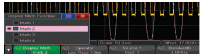
图31: 用户可创建4种运算函数, 并将它们嵌套到1种运算函数中。
