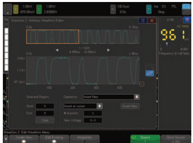
图 22: WaveGen 任意波形编辑屏幕。
