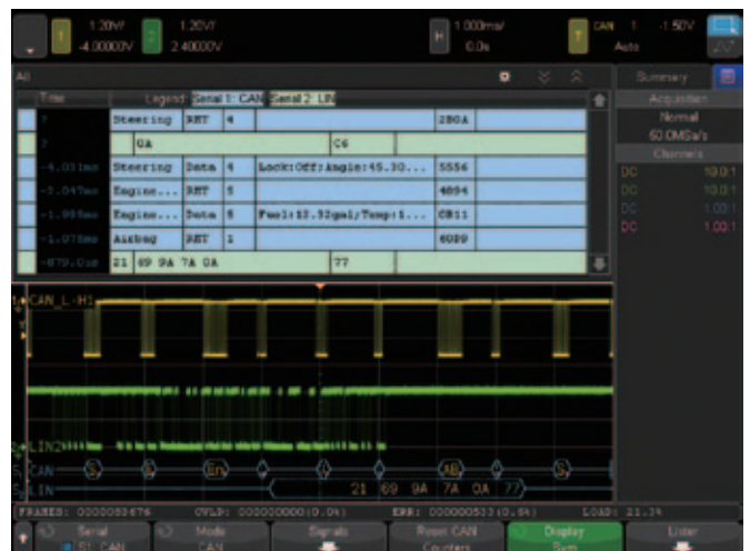
图 19: 双路串行总线 CAN 和 LIN 解码和交叉“列表”显示。
