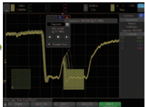
图 16: InfiniiScan 区域触摸触发与分段存储器结合使用的结果。
